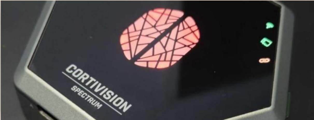
LED rouge : faisceaux mal connectés.
