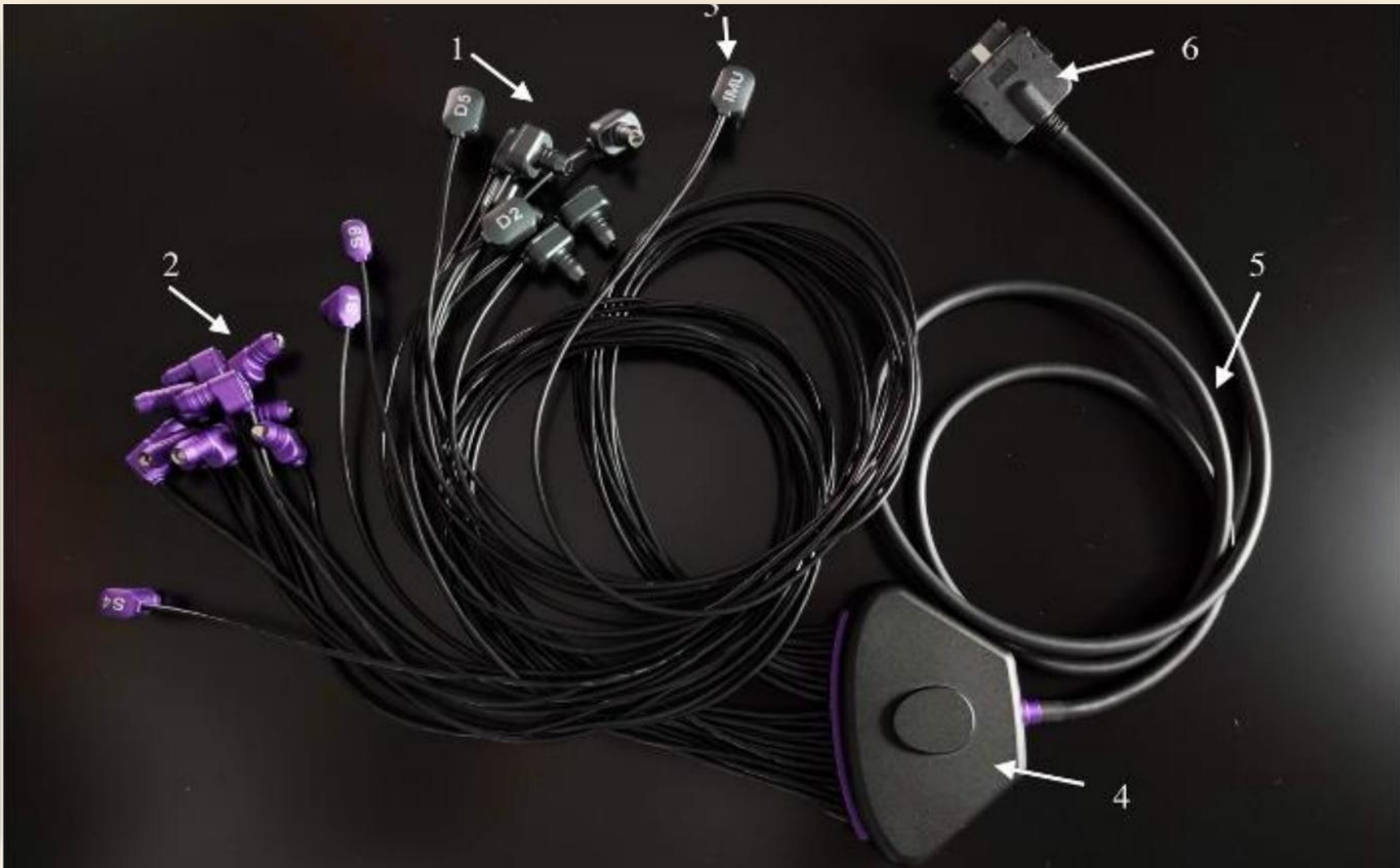
Faisceau d'optodes : détecteurs, émetteurs 760 / 850 nm, module IMU.
