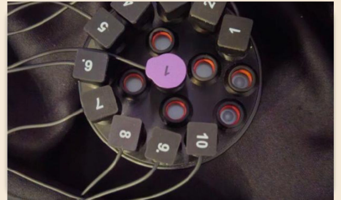
Optodes autour de l'optode centrale dans le phantom.
